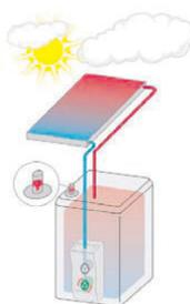
Os dois circuladores irão, numa primeira fase, forçar a água a passar pelos colectores, deslocando para os depósitos, o ar que aí se encontra. Quando estiver assegurado que no sistema circula somente água, um dos circuladores pára, sendo a circulação de água assegurada por um único circulador.
